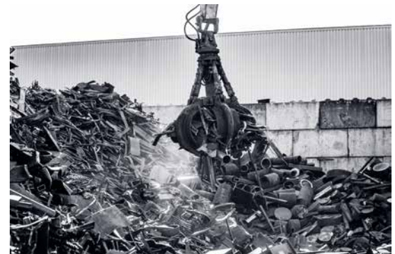
Aufbereitung: Das Metall wird vor der Weiterverarbeitung sortiert
