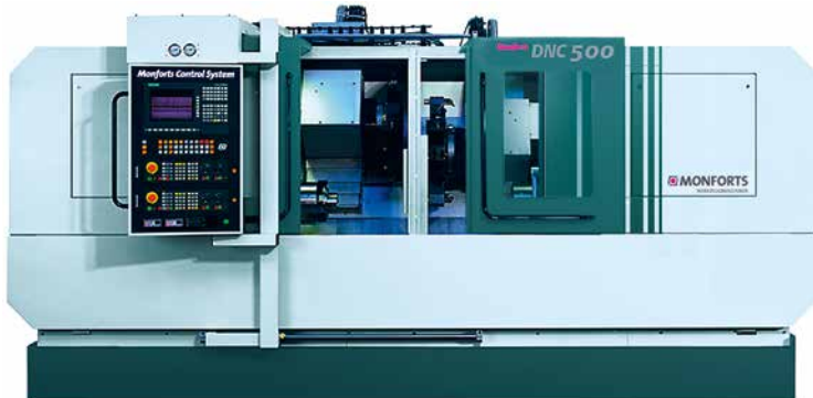
Zwei in eins mit DNC 500: Die Ausstattung mit zwei Werkzeugaufnahmen und zwei Spindeln ermöglicht die beidseitige komplette Bearbeitung von Bauteilen
