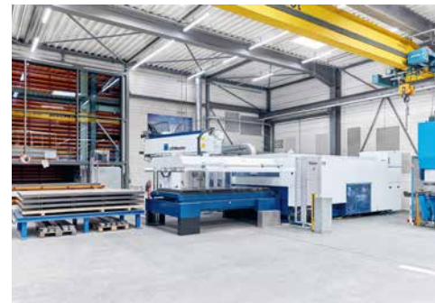
Auf dem Weg zur digitalen Produktion: Vollautomatisches Lager (L), Beladeroboter (M.) und TruLaser 5030
