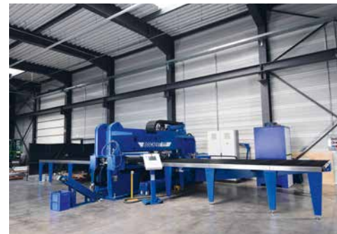
CNC-Stanz- und Nippelmaschine: Boschert Multipunch 5200
