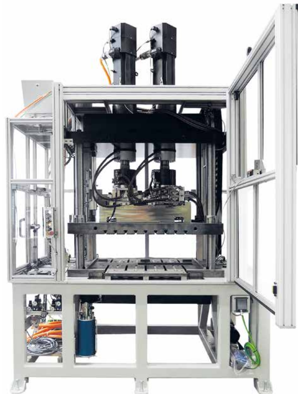
Hightech-Antriebstechnik: Servo-elektrische Presse zur Herstellung von Steckkontakten
