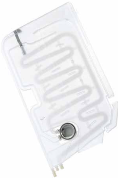
Wärmetauscher für die Geschirrspülmaschine, intelligente Etimex-Technik mit Mehrwert: Das zugeführte Wasser wird durch warmes Abwasser erhitzt
