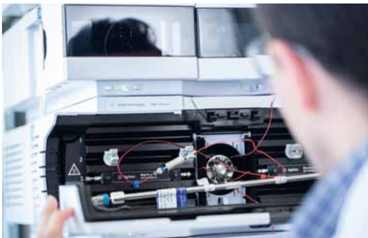
Eine HPLC-Anlage. 'HPLC' steht für Hochleistungsflüssigchromatographie
