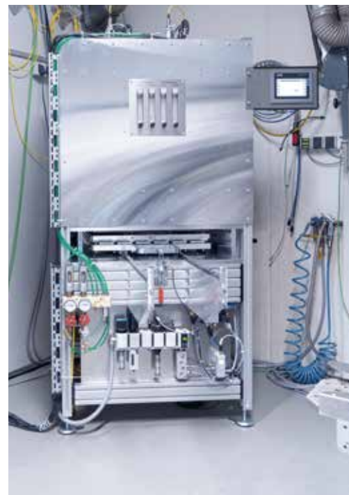
Produkte von morgen: Bipolarplatten, wichtige Elemente einer Brennstoffzelle, werden bei Weil bereits auf der Serientechnologie geschweißt
