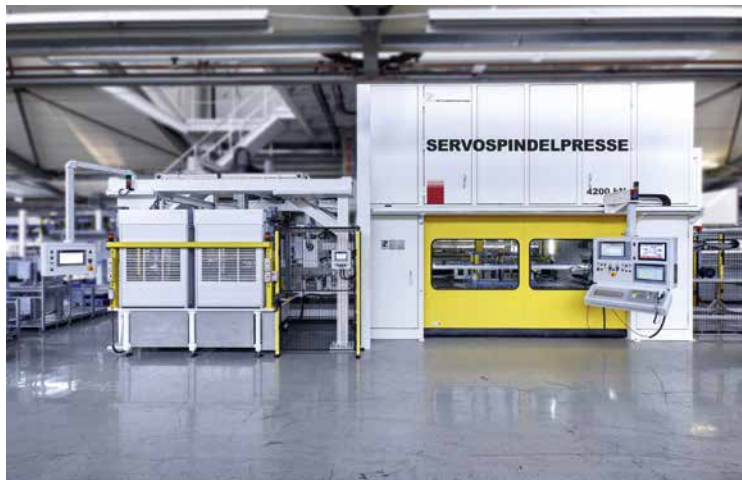
Dank der hochpräzise angetriebenen Servoachsen setzt die Servospindelpresse einen neuen Maßstab für Genauigkeit und auch Dynamik
