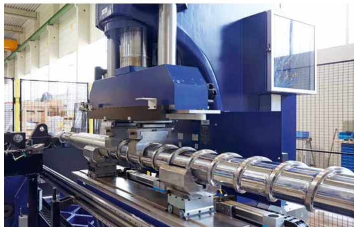
Präzisionsarbeit: Richten von Extruderschnecken
