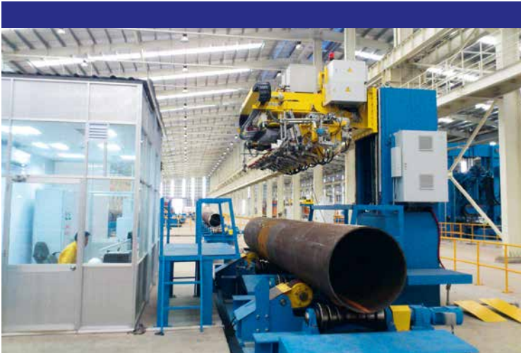
Das Prüfsystem NORDISCAN-PI-1530 ermöglicht die automatische Ultraschallprüfung von Rohrleitungen an Schweißnähten, Rohrkörper und Rohrenden
