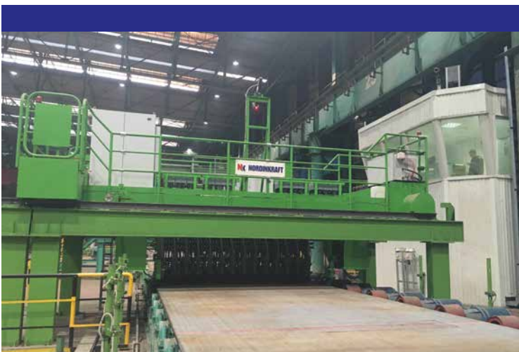
Die Prüfanlage EMATEST-PL-3500 wurde für die berührungsfreie Ultraschallprüfung von gewalzten Metallplatten entwickelt
