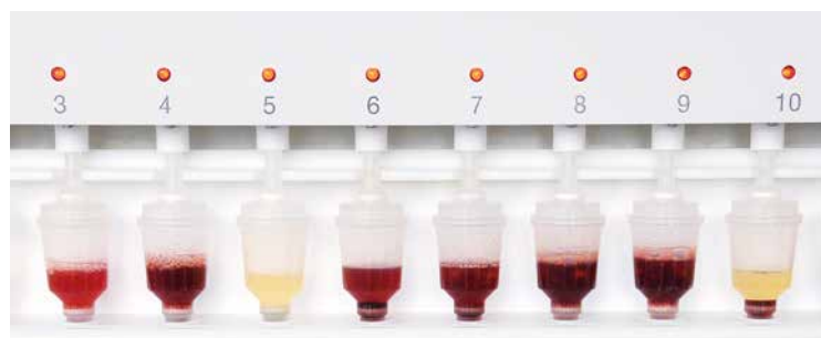
In jedem der acht Gefäße wird ein Peptid synthetisiert
