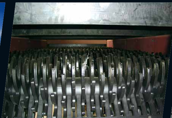
Die Fingerrollenroste werden als Siebmaschinen genutzt
