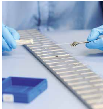
Die Arrays werden für die Herstellung der Peptide Microarrays vorbereitet
