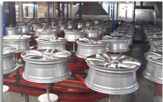
Importante area d'attività: verniciatura in polvere di cerchi in lega leggera
