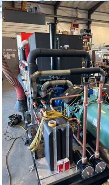
Eine Kältemaschine mit Kolbenverdichter
