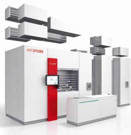
Der modulare Kommissionierautomat Cube+ für Apotheken hat eine Kapazität von bis zu 20.000 Packungen und kann einfach nachträglich erweitert werden
