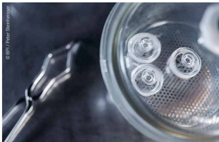
Trocknungsprozess im Labor: Exsikkator mit Glasbehältern
