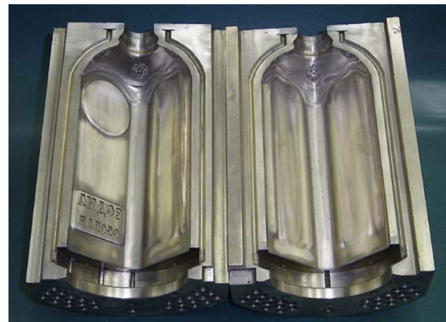
Im Glasformenbau realisiert die AB-Tec auch komplexe Formen
