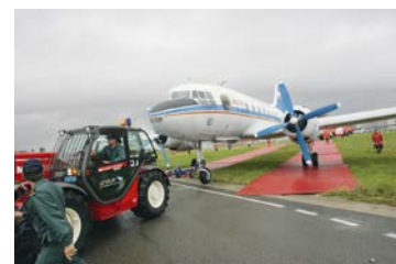
Dank scobamat lassen sich Flugzeuge auf unbefestigtem Terrain schnell bergen
