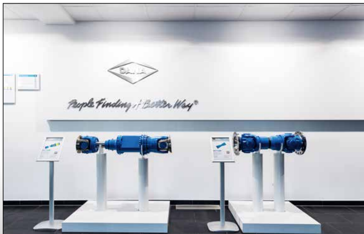
Hightech für Hochgeschwindigkeitszüge: links die innovative, von Danas GWB-Marke entwickelte Tripode mit Sicherheitskupplung, rechts eine Standardwelle
